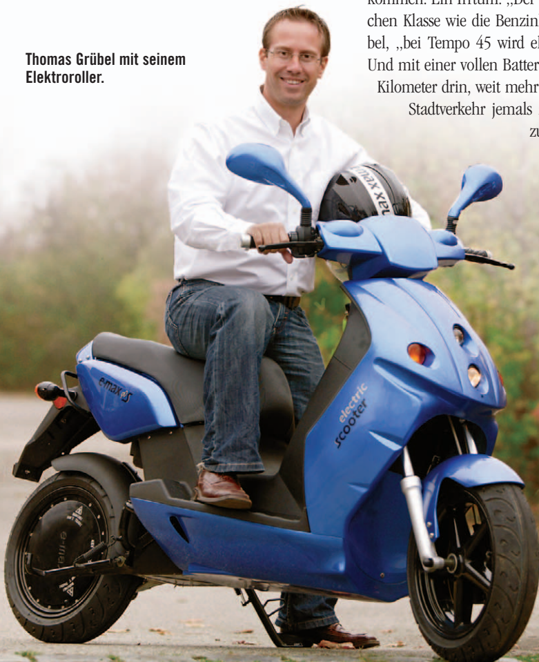
Klein und ohne mechanische Verschleißteile werkelt der Elektromotor des E-Max im Hinterrad.
